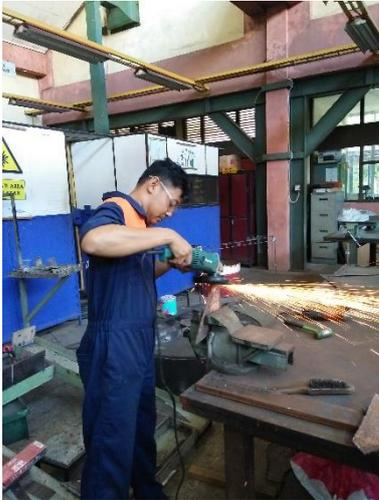
Gambar 7. Pembuatan Plat Penguat Rangka
