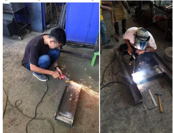
Gambar 5. Proses Pembuatan Landasan Pengempa
