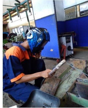
Gambar 9. Proses Pengelasan Tapak Ke Rangka
