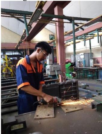
Gambar 8. Proses Pembuatan Tapak Alat Press
