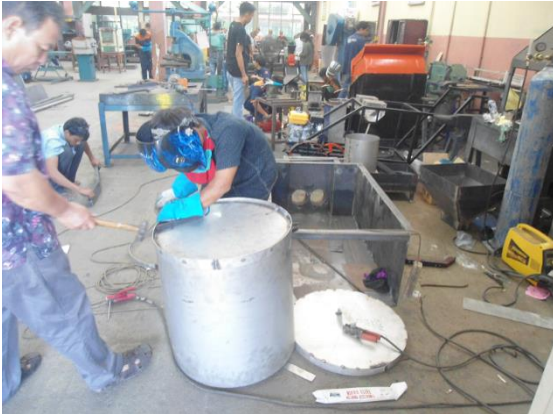
Gambar 6. Proses Pengelasan Alas pada Silinder Presto
