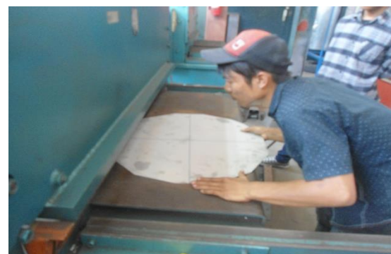
Gambar 5. Proses Pemotongan Alas dan Tutup Presto
