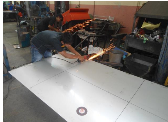
Gambar 3. Proses Pemotongan Material Silinder Presto
