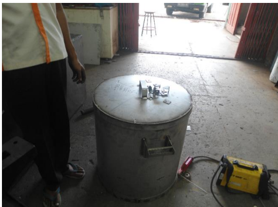
Gambar 8. Pemasangan Tutup Presto
