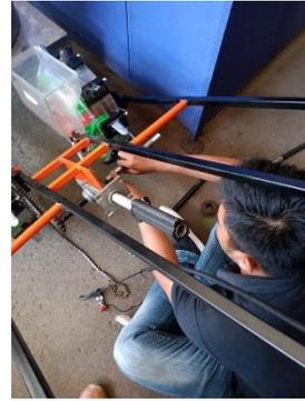
Gambar 11. Proses Pemasangan Transmisi
