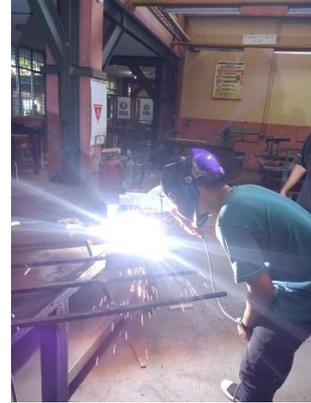
Gambar 5. Proses Pengelasan Rangka
