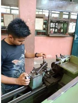
Gambar 8. Proses Pembubutan Gear Nozzel
