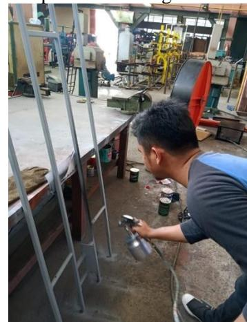
Gambar 12. Proses Pengecatan
