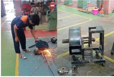
Gambar 4. Proses Pembuatan Rangka Mesin
