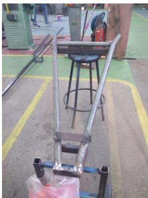
Gambar 7. Rancangan rangka mesin penyanggul gulma
