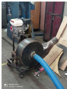
Gambar 11. Pemasangan pipa hisap
