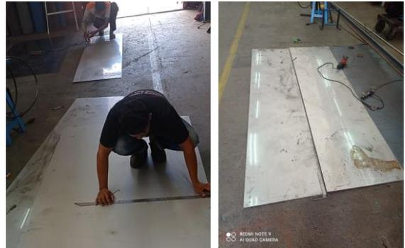
Gambar 5. Proses marking dan pemotongan plat bakal tabung penyuling
