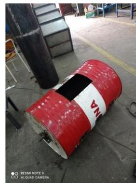
**Gambar 5.** Pemotongan Pada Silinder
