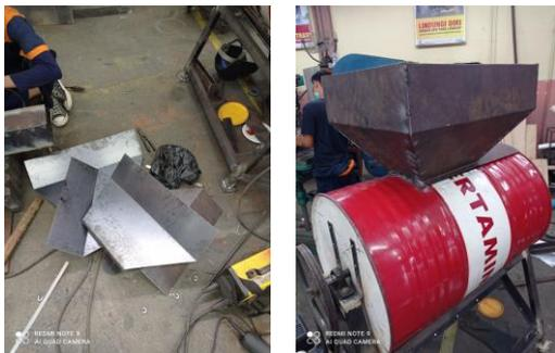
**Gambar 8.** Proses Pembuatan Corong Masuk
