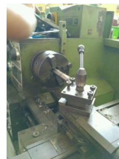
Gambar 7. Proses Penbubutan Poros
