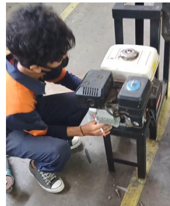
Gambar 6. Pemasangan Dudukan Motor Penggerak
