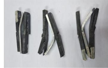
**Gambar 6.** Bentuk Patahan Benda Uji Aluminium dengan Lapisan 5 mm
