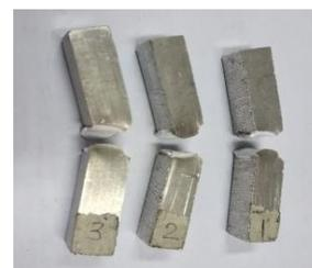
**Gambar 4.** Bentuk Patahan Benda Uji Aluminium tanpa Lapisan
