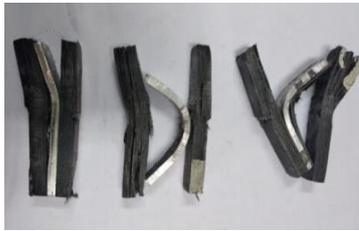
**Gambar 7.** Bentuk Patahan Benda Uji Aluminium dengan Lapisan 7 mm
