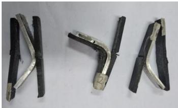
**Gambar 5.** Bentuk Patahan Benda Uji Aluminium dengan Lapisan 3 mm
