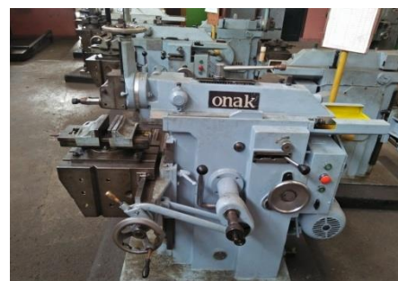
Gambar 1. Mesin Sekrap Onak Type L-350 (Sumber : laboratorium Permesinan Jurusan Teknik Mesin FT-UNP).
