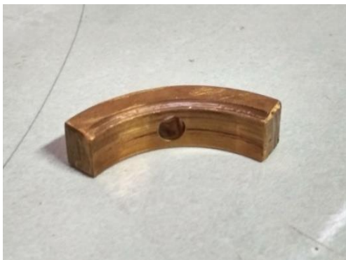
Gambar 6. Bronze /Kuningan pada Kopling Mesin Sekrap Onak Type L-350.
