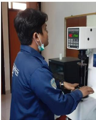
**Gambar 2.6** Proses Pengujian Kekerasan
