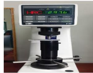
**Gambar 2.3** Mesin Uji Kekerasan *Rockwell*
