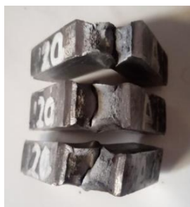
Gambar 8. Bentuk Patahan Spesimen dengan Pengelasan Kuat Arus 120 Ampere.
