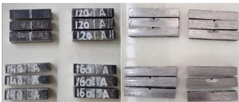
Gambar 6. Spesimen setelah dibentuk untuk Uji Impak Standar ASTM E23.
