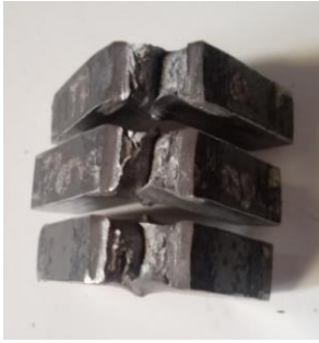
Gambar 7. Bentuk Patahan Spesimen Kontrol atau Tanpa Pengelasan
