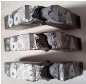
Gambar 10. Bentuk Patahan Spesimen dengan Pengelasan Kuat Arus 160 Ampere.
