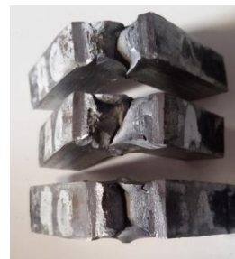
Gambar 9. Bentuk Patahan Spesimen dengan Pengelasan Kuat Arus 140 Ampere.
