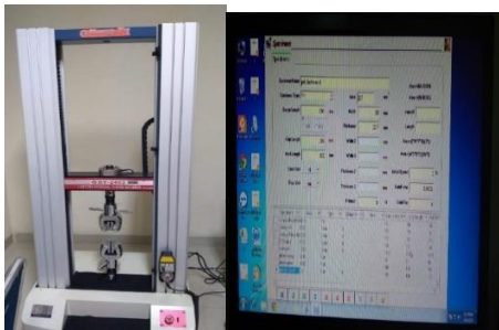
Gambar 6. Setting Mesin UTM HT 2402 (sumber: Laboratorium Manufaktur Teknik Mesin UNP)
