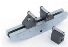
Gambar 7. Dudukan uji bending jenis rol silinder (Sumber: (Yalcin, 2016))
