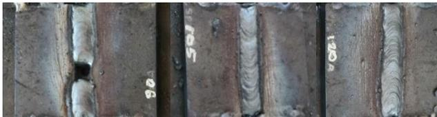
**Gambar 4.** Specimen Kampuh V setelah Pengelasan
