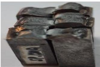
**Gambar 11.** Bentuk Patahan Kuat Arus Pengelasan 105 A
