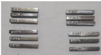
**Gambar 5.** Specimen setelah dibentuk untuk uji impact Standar ASTM E23
