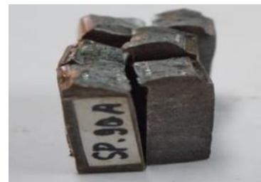
**Gambar 9.** Bentuk Patahan Kuat Arus Pengelasan 90 A
