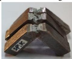
**Gambar 8.** Bentuk Patahan Baja ST 42 Tanpa Pengelasan
