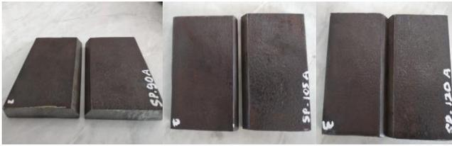
**Gambar 3.** Specimen Kampuh V sebelum Pengelasan
