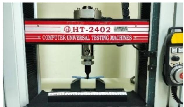
**Gambar 3.** Proses Pengujian *Bending*.
