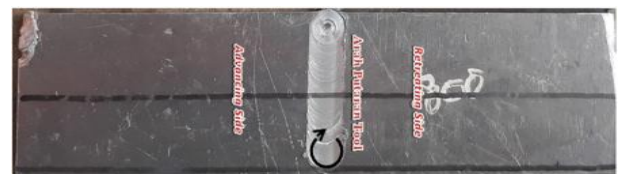
Gambar 1. Hasil Tampak Atas Pengelasan FSW 800 rpm
