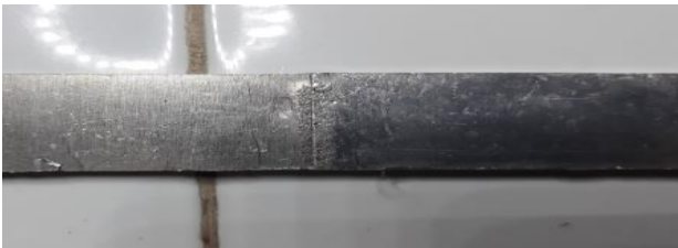
Gambar 4. Hasil Tampak Bawah Pengelasan FSW 800 rpm
