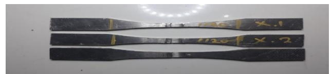
Gambar 19. Penampang Patahan Tampak Atas Spesimen Pengelasan Variasi Kecepatan Putar Tool 1120 rpm
