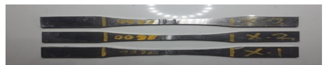
Gambar 20. Penampang Patahan Tampak Atas Spesimen Pengelasan Variasi Kecepatan Putar Tool 1600 rpm
