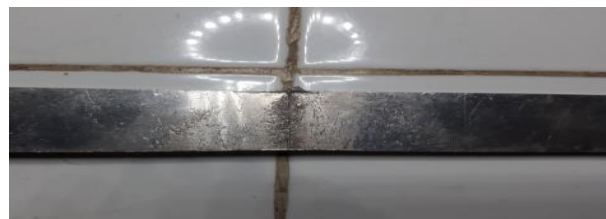
Gambar 6. Hasil Tampak Bawah Pengelasan FSW 1600 rpm
