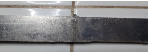
Gambar 5. Hasil Tampak Bawah Pengelasan FSW 1120 rpm
