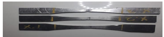
Gambar18. Penampang Patahan Tampak Atas Spesimen Pengelasan Variasi Kecepatan Putar Tool 800 rpm
