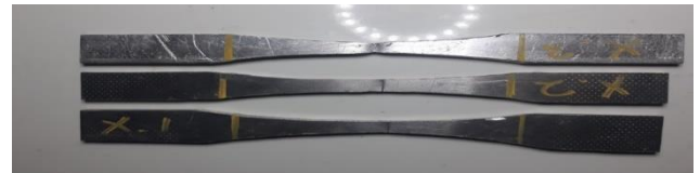
Gambar 17. Penampang Patahan Tampak Atas Spesimen Pembeding
