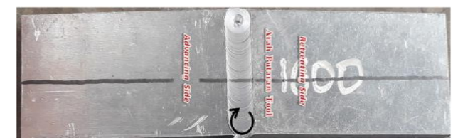
Gambar 3. Hasil Tampak Atas Pengelasan FSW 1600 rpm
