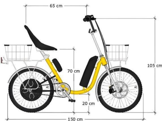
Gambar 3.11. Desain 3D sepeda listrik (Siregar, dkk 2021)
