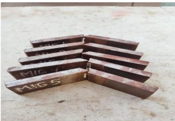
**Gambar 3.2.** Bentuk Spesimen Las MIG Setelah *Bending Test*
