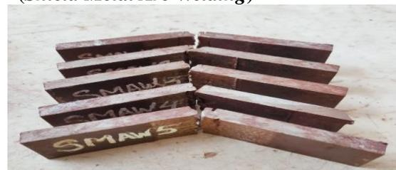
Gambar 3.1. Bentuk Spesimen Las SMAW
