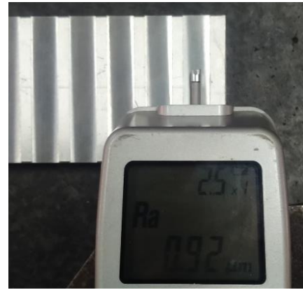
Gambar 2.9. Pengukuran Nilai Ra pada Titik T2
