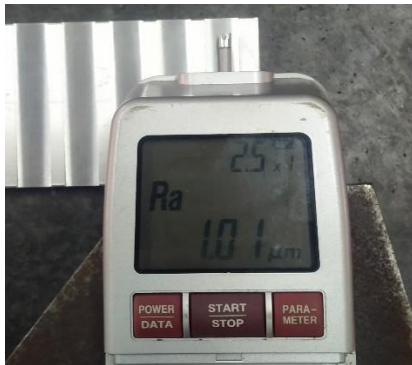
Gambar 2.8. Pengukuran Nilai Ra pada Titik T1
