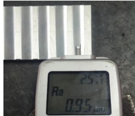
Gambar 2.10. Pengukuran Nilai Ra pada Titik T3
