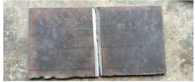
Gambar 2.1. Setelah dilakukan Pembuatan Kampuh
