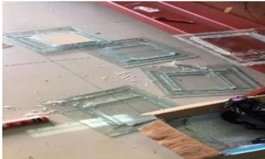
Gambar 2.2 Cetakan Spesimen
