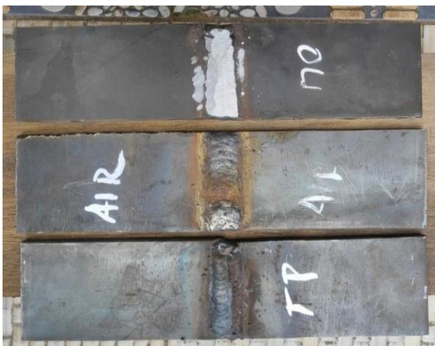
**Gambar 1.4 Setelah dilakukan Pengelasan dan Pendinginan**
