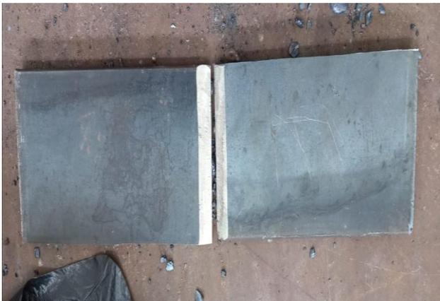
**Gambar 1.3. Setelah dilakukan Pembuatan Kampuh.**
