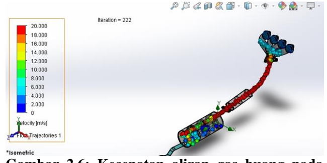
Gambar 2.6: Kecepatan aliran gas buang pada exhaust manifold
