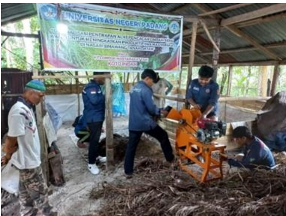
Gambar 6. Uji Kinerja dan Demonstrasi Penggunaan Alat Pencacah Serai Wangi
