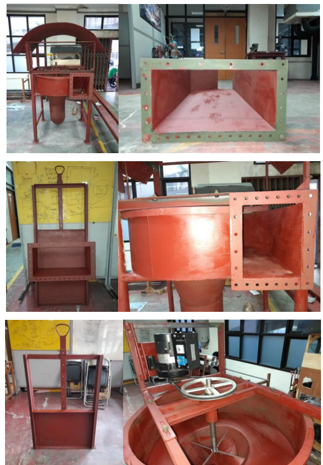
Gambar 3.5. Rancang angun PLMTH Berskala Kecil Menggunakan Turbin Model Vortex
