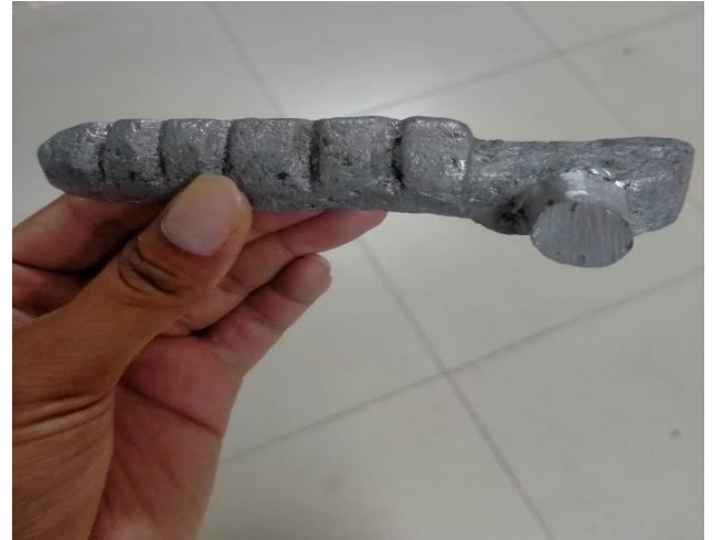
Gambar 8. Hasil Coran Footstep Sebelum Finishing
