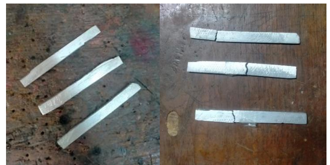
Gambar 14. Spesimen Sebelum dan Sesudah diuji Tarik
