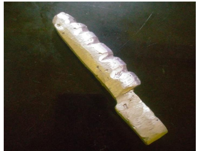
Gambar 9. Hasil Coran Setelah Finishing
