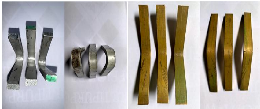
Gambar 9. Hasil Uji Bending (A) dan (B)
