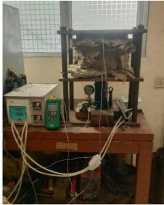
Gambar 8. Heater dan Press Hidrolik
