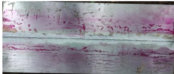
Gambar 7 Hasil dye penetrant las arus 160 A
