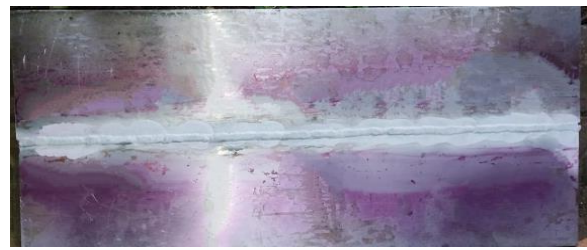
Gambar 6 Hasil dye penetrant las arus 130 A
