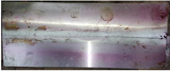
Gambar 5 Hasil dye penetrant las arus 100 A
