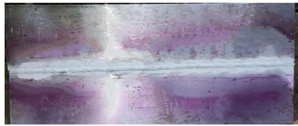
Gambar 5. Hasil *dye penetrant* las arus 130 A
