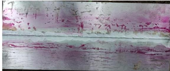
Gambar 6. Hasil *dye penetrant* las arus 160 A
