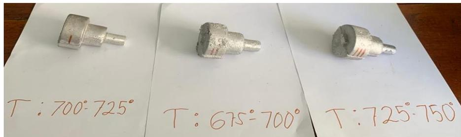
Gambar 2: hasil pengecoran aluminium
