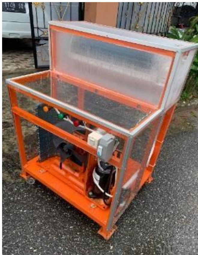
Gambar 1. Alat Simulasi AC Split
