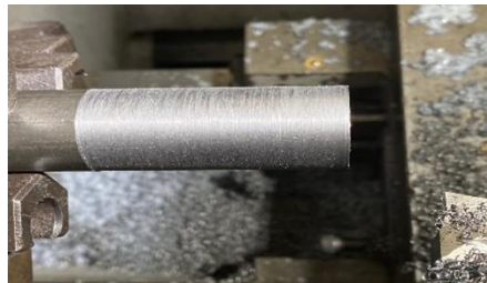
Gambar 3 Spesimen sesudah pembubutan
