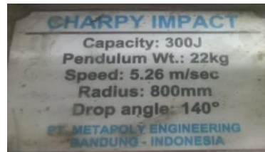
Gambar 9. Spesifikasi Alat Uji Impak Charpy
