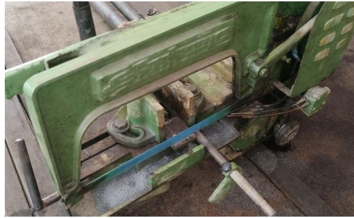
Gambar 6. Pemotongan Spesimen Impak
