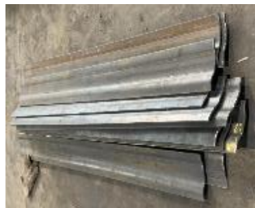
Gambar 5. Plat Baja Karbon SS400 Tebal 6mm
