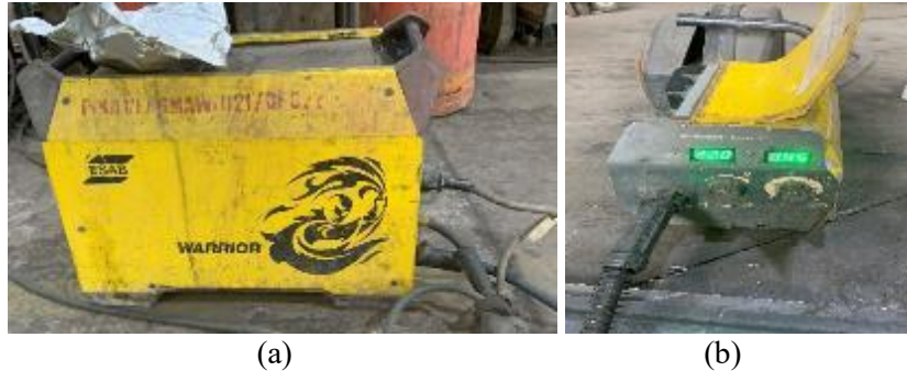
Gambar 9. (a) Mesin Las Warrior 500i CC/CV MIG, dan (b) Feeder
