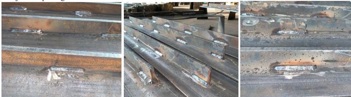
Gambar 13. Hasil pengelasan dengan plat tebal 10mm dengan 6mm
