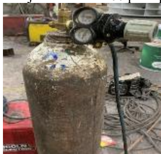
Gambar 8. Tabung dan Gas pelindung CO 2
