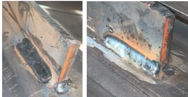
Gambar 19. Cacat pengelasan surface concavity pada apron feeder
