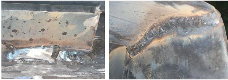
Gambar 18. Cacat pengelasan stop-start pada apron feeder
