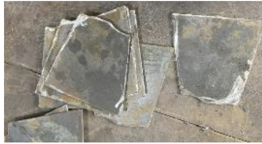
Gambar 4. Plat Baja Karbon SS400 Tebal 4mm
