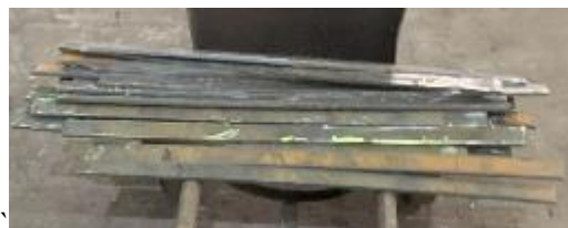
Gambar 6. Plat Baja Karbon SS400 Tebal 10mm
